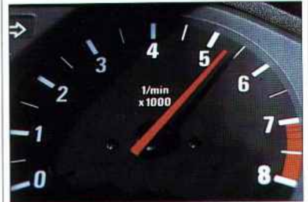
Zur Sicherheit. Um Schäden vorzubeugen, unterbricht knapp über 7250/min der Drehzahlbegrenzer den Schub.
