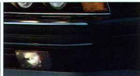
Mehr Sicherheit. Die neuen Stoßfänger überstehen Kollisionen mit bis zu 4 km/h ohne blei-
