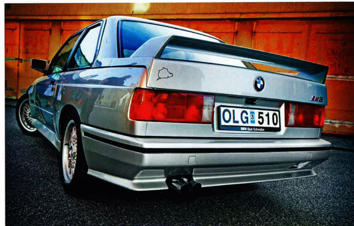
DET MESTA UNIKT. M3 har inte mycket gemensamt med vanliga 3-serien. Det är i princip bara motorhuven som är identisk – och baklyktorna förstas! Övriga 3-serieprogrammet fick nya 1988.
