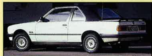
INTE RIKTIG cabriolet men i alla fall. Det här är en 84:a, och valören är 318i. Det var karosseriefirman Baur i Stuttgart som byggde dessa bilar, som egentligen är mest lika forna tiders så kallade cabriococh, dvs med ett jättestort soltak, som även inkluderar bakrutan.
