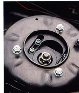
VINKEL. Topplagringarna tillåter 1,5–4 grader negativ camber.
