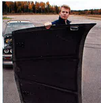
LÄTT. Gråmålad utsida, men visst är det kolfiber. Äkta raceplast, som ska lackas.
