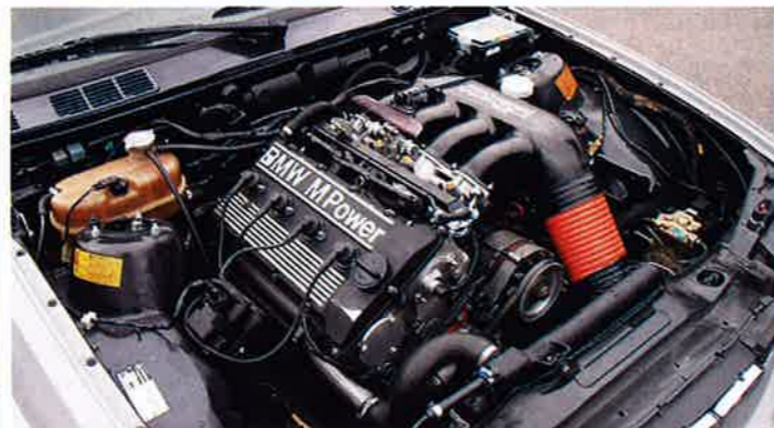
NÄSTA STEG. Med 270 hästar på topp är motorn redan rejält trimmad. Taket har dock inte nåtts. Det finns mer att hämta, utan överladdning!
